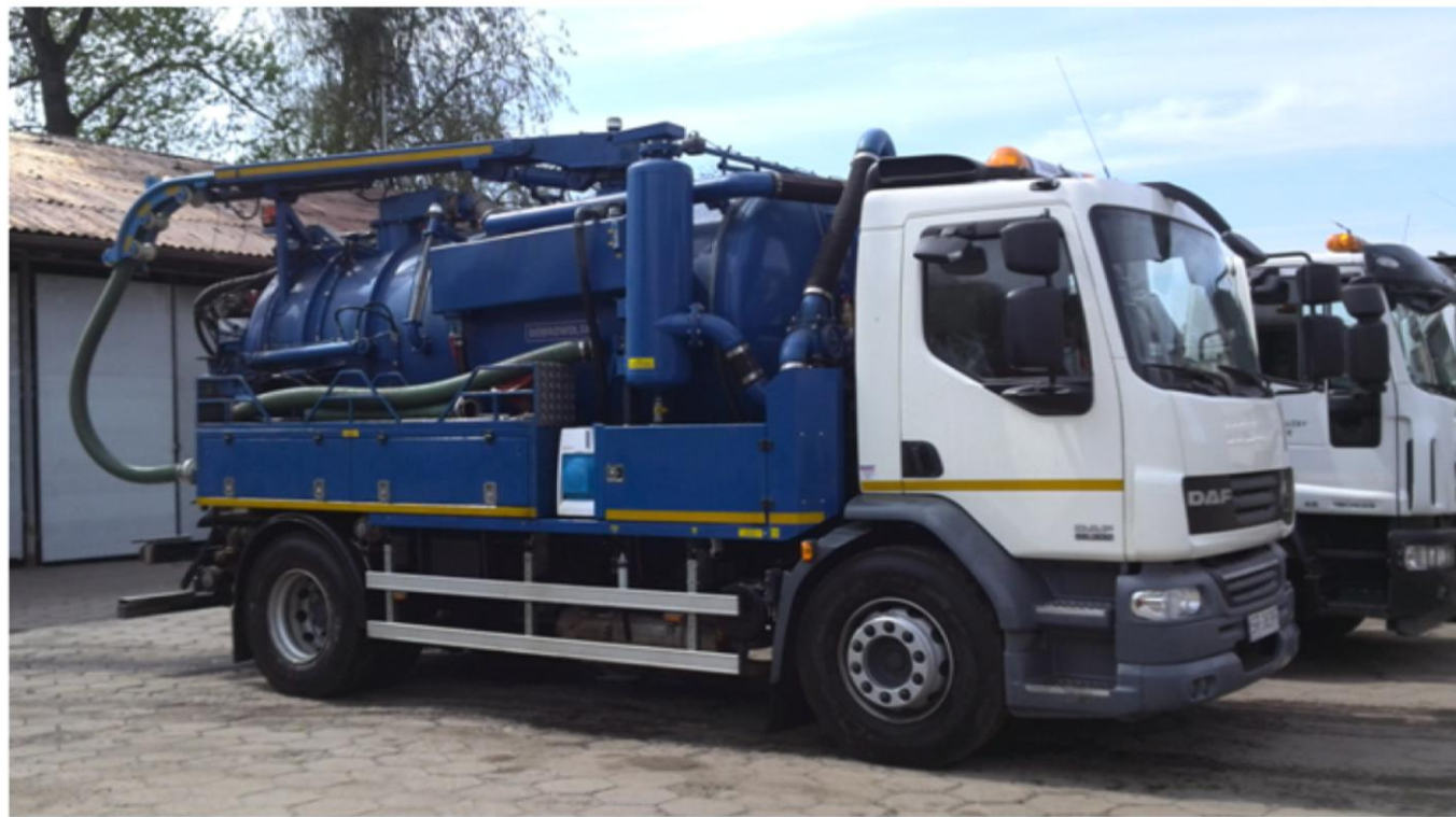
Samochód WUKO do czyszczenia kanalizacji – 816.966 zł
